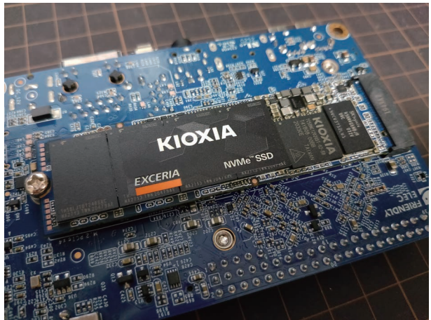
図 2: NanoPC-T4 に EXCERIA SSD を搭載
