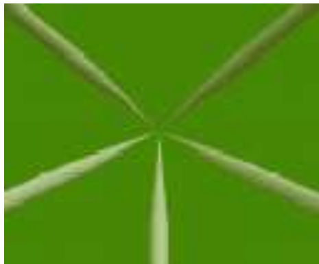
図4-6-7 ナノプローブ装置のプローブ端子先端写真 (先端径は50 nm)
