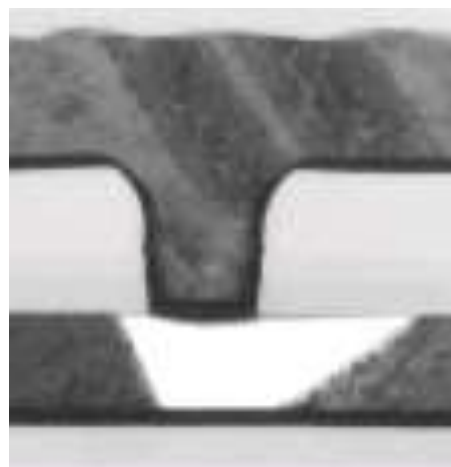
図 2-1-6-1 CuプロセスのVia下部に発生したボイドの観察像
